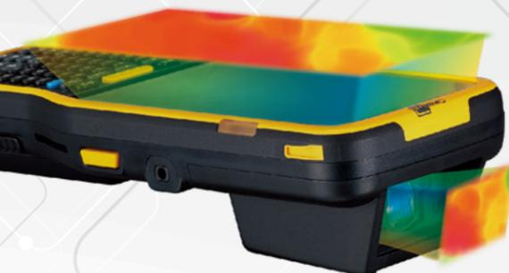
✓ Sensor de temperatura y calentador controlado por software permitiendo activar y desactivar el calentador de forma precisa y automática de acuerdo al ambiente que se encuentre. Por ejemplo, establecer activación de calentador por debajo de -10°C y desactivar por encima de 20°C.
